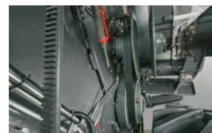
Cséplődobhajtás két egyszerűen beállítható fordulatszám tartománnyal
