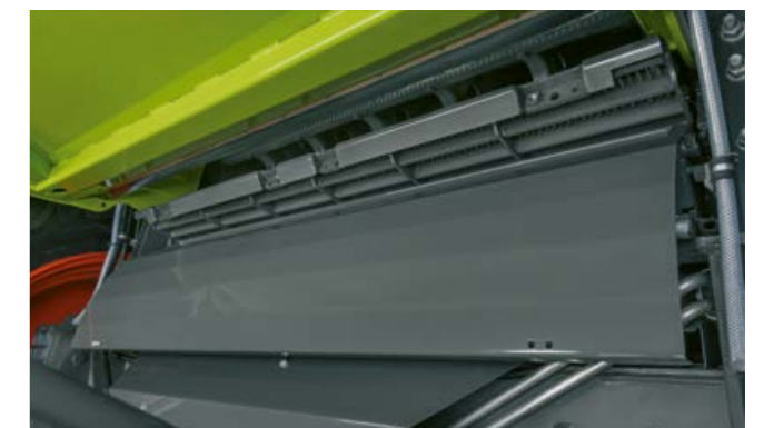
A kosárszegmens könnyen kihúzható a kőgyűjtővályún keresztül.
